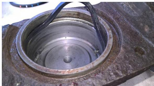
Einsetzen des neuen Dichtringes im Zylinder
