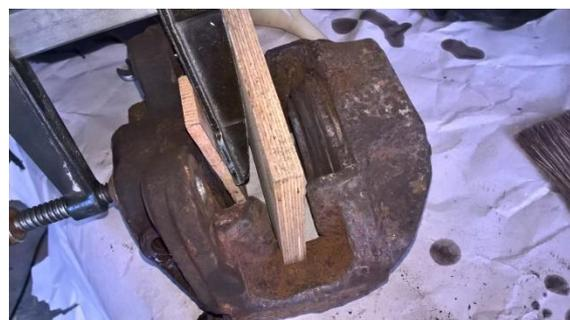
Ausdrücken der Kolben per Druckluft
