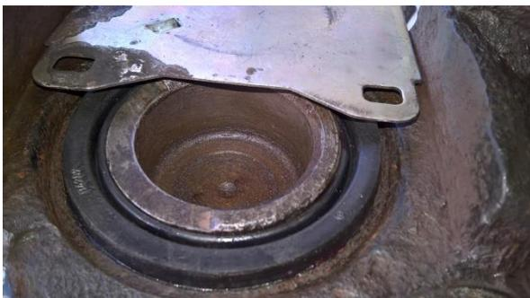
Ausrichten der Kolben auf die Nut der Sicherungsbleche
