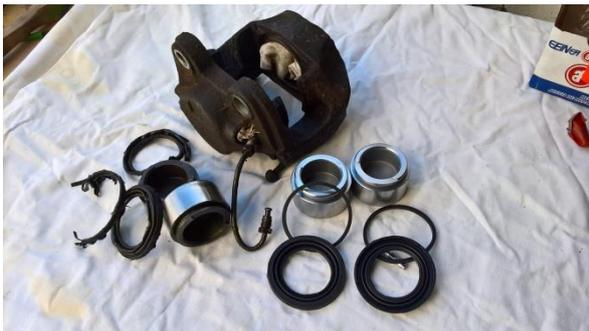
Gereinigter Bremssattel mit alten (li) und neuen (re) Teilen
