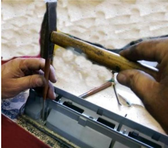
Anschließend das Gehäuse auf eine feste Unterlage legen und mit einem Durchschlag und leichten Schlägen die Stehbolzen entfernen.
