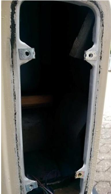
Den Lampenträger wieder ins Gehäuse einsetzen und das ganze Teil wieder in die Karosserie einpassen. Anschließend mit den zu den Blechmuttern passenden Kreuzschlitzschrauben mit einer Länge von 25mm und einer Unterlegscheibe festschrauben.
